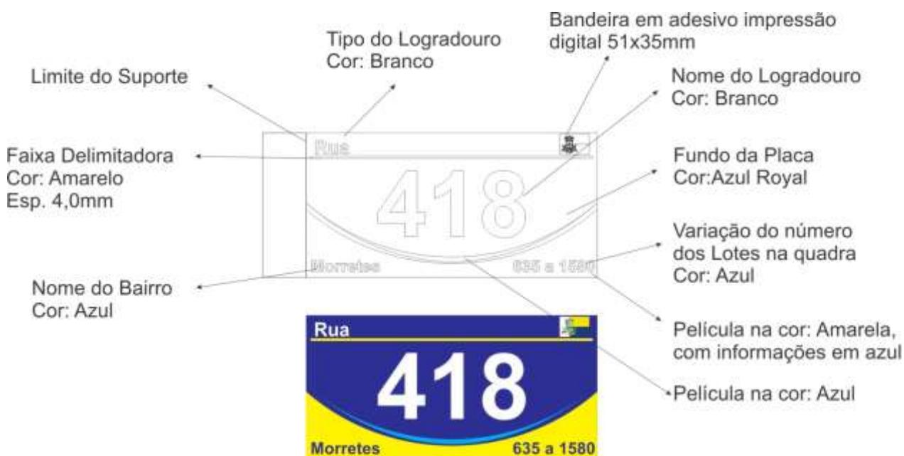
**Material:** Chapa de ferro galvanizado à fogo (esp. mínima 1,25 mm)
