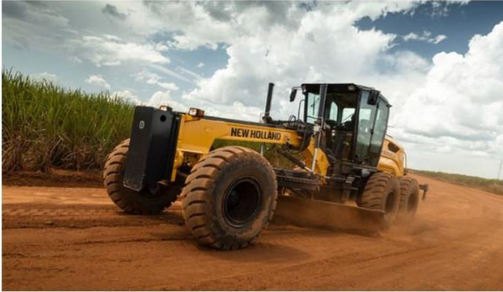
A motoniveladora RGI170.B EVO se destaca pela alta tecnologia e pela eficiência, com comandos hidráulicos de elevada precisão, articulação do chassi à frente da cabine, lâmina central Roll Away com perfil evolvente e transmissão de controle eletrônico inteligente.
