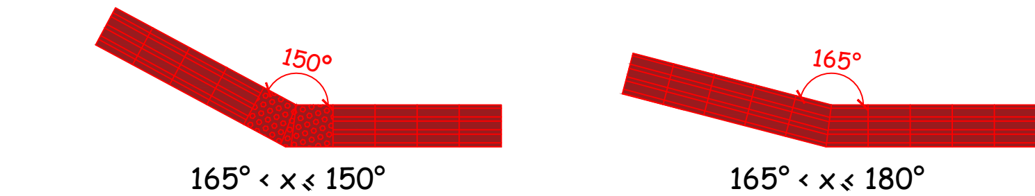
MUDANÇA DE DIREÇÃO DE PISO TÁTIL (ALERTA E DIRECIONAL) ESCALA 1:20
