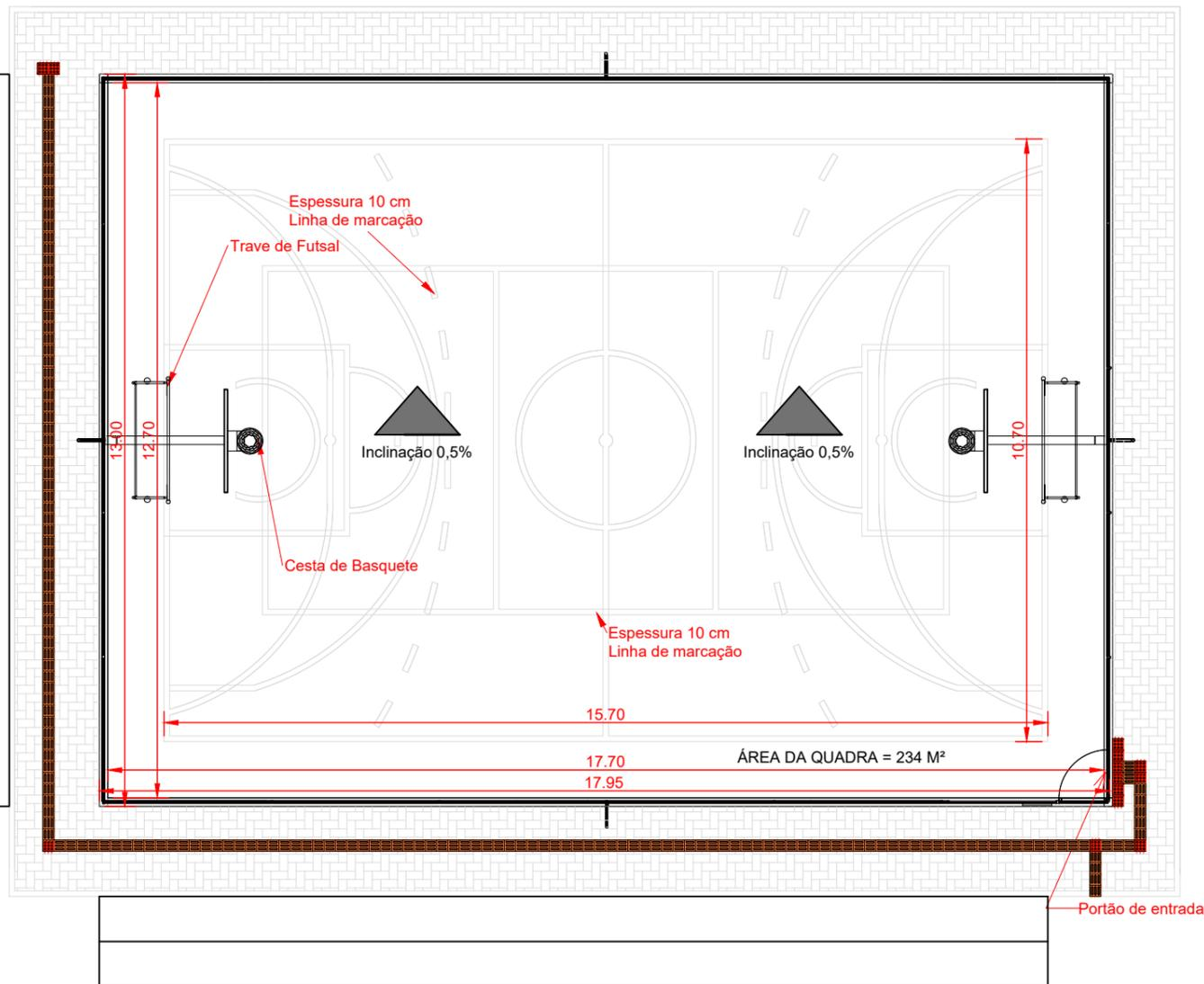
BASE: SOLO COMPACTADO E NIVELADO COM INCLINAÇÃO DE 0,5% E
